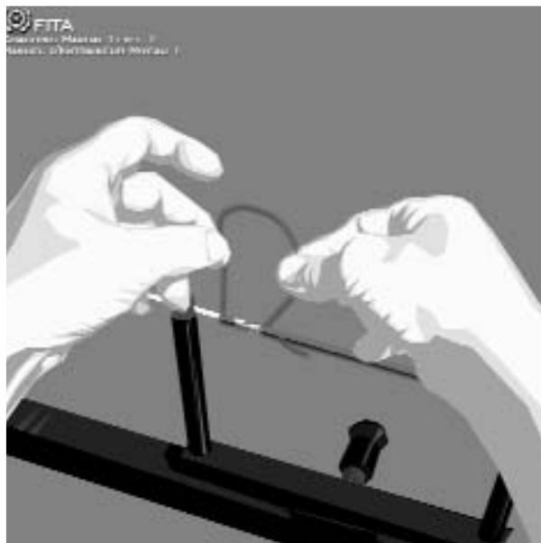
En enroulant manuellement la partie droite du fil renfort, vous dérouler sa partie gauche. Note: Il s'enroule alors sur sa propre extrémité.
